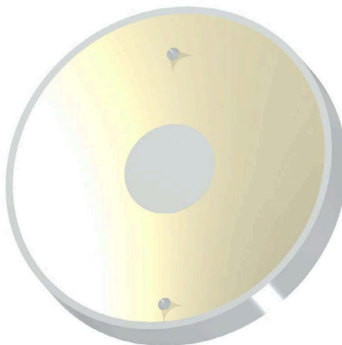
Рисунок 1.25 – Внешний вид рассчитанного входного зеркала для многопроходной системы Эрриотта.
