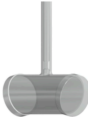
Рисунок 1.14 – Однопроходная кювета из кварцевого стекла с окнами, расположенными под углом 11^\circ .
