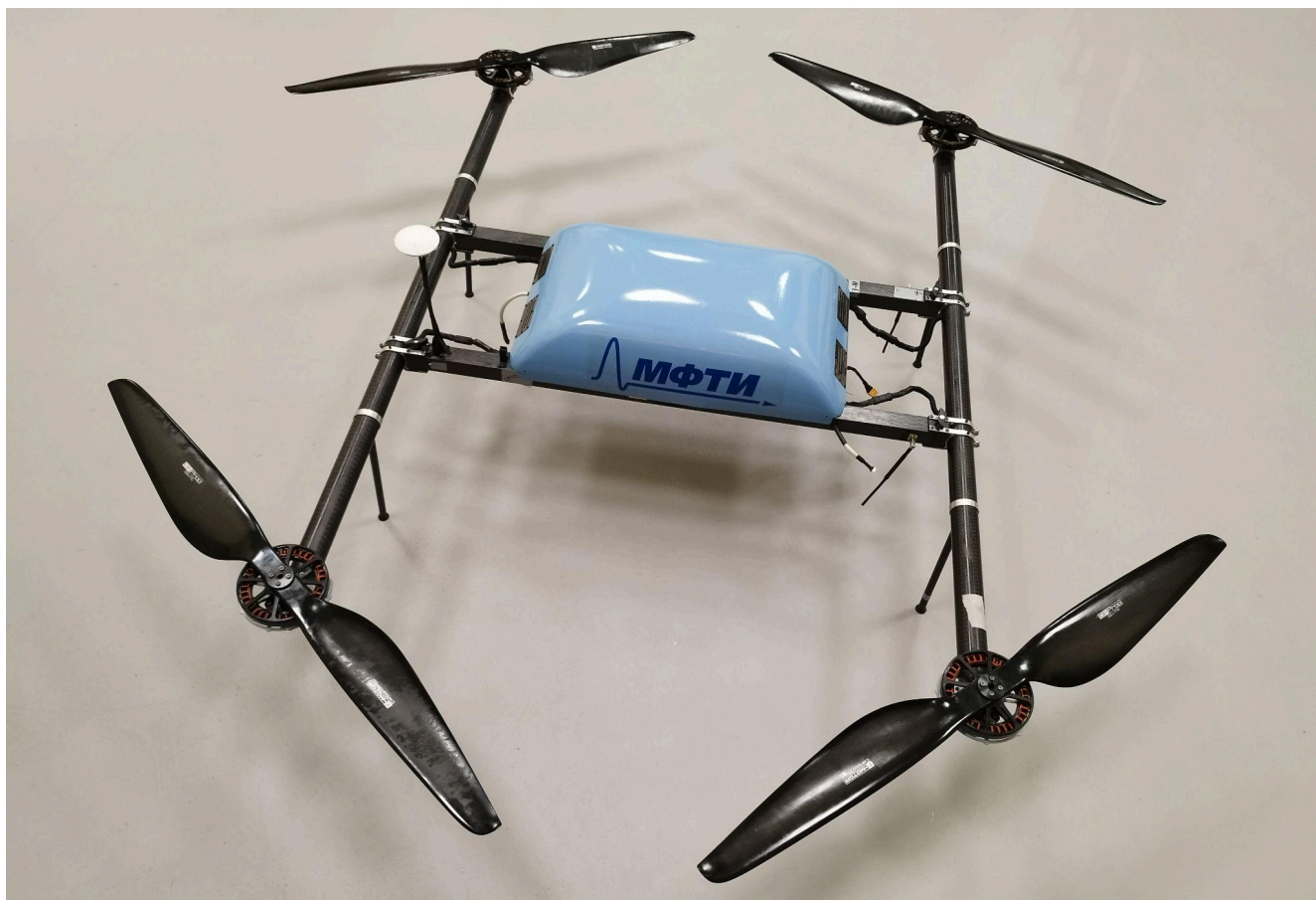
Рисунок 3.6 – Квадрокоптер «Ирбис-432» с максимальной полезной нагрузкой ~8 кг, эксплуатируемый в МФТИ.
