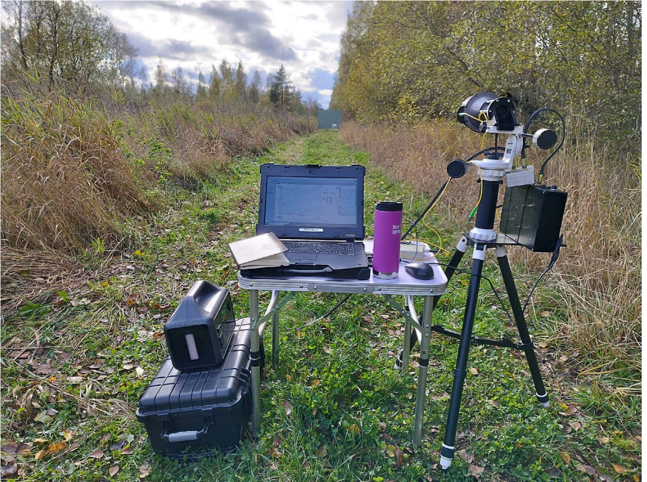
Рисунок 4.23 – Пример организации эксперимента с использованием прототипа газоанализатора ГИМЛИ, установленного на треногу, в горизонтальном режиме с наведением внешнего оптического блока прибора на вертикально установленный экран.
