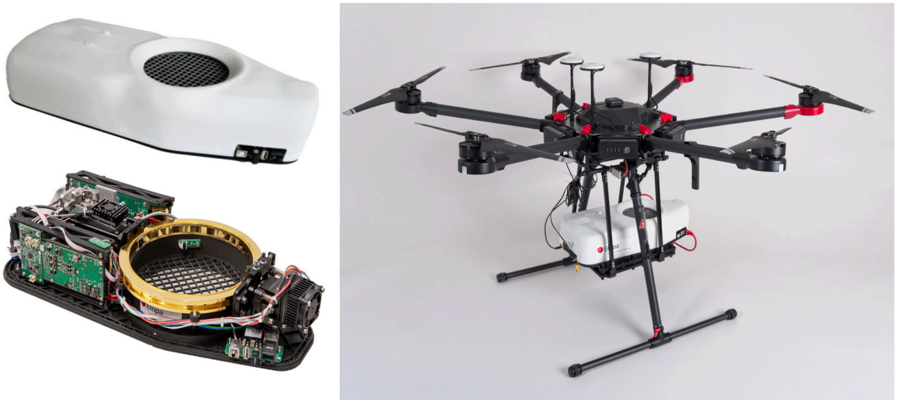
Рисунок 1.33 – Лазерный спектрометр, основанный на применении сегментированной круговой МГК (слева). Прибор, установленный на гексакоптер DJI Matrice 600 (справа) [99].
