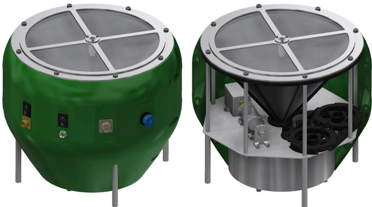
Рисунок 4.48 – Модель корпуса прибора с акриловой линзой Френеля диаметром 200 мм.
