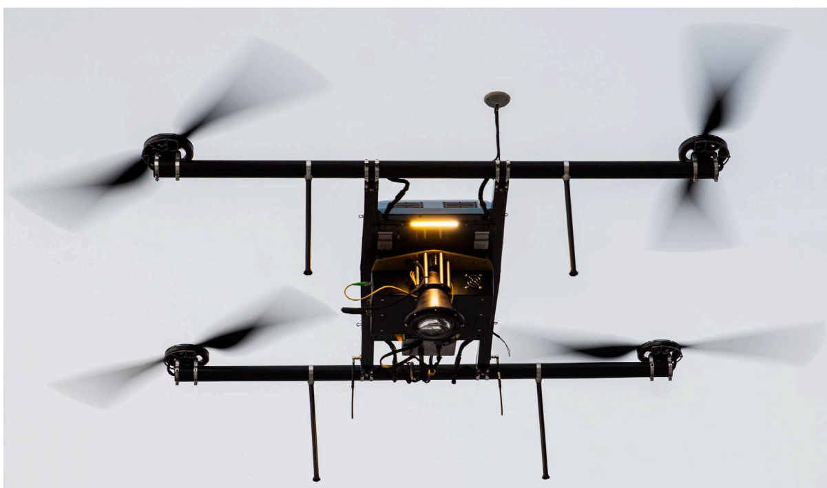
Рисунок 4.12 – Прототип газоанализатора ГИМЛИ на борту квадрокоптера «Ирбис-432».
