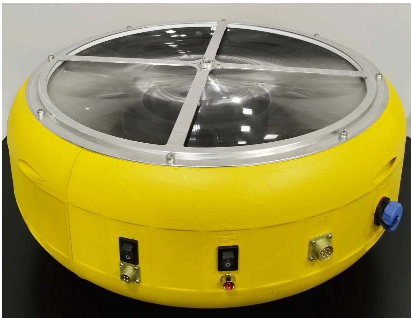
Рисунок 4.50 – Внешний вид версии прибора с акриловой линзой Френеля диаметром 350 мм.
