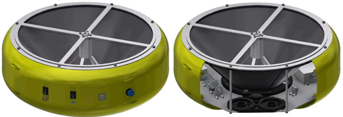
Рисунок 4.45 – Модель корпуса прибора с акриловой линзой Френеля диаметром 350 мм.
