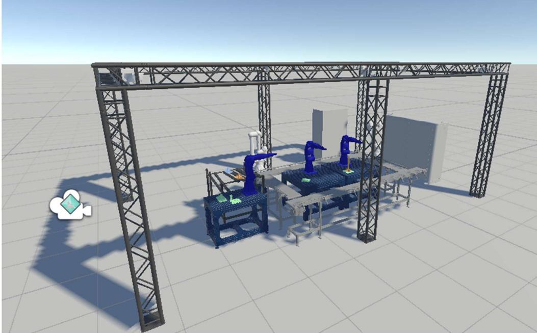
**FIGURE 6:** DIGITAL TWIN REPRESENTATION OF THE FUTURE FACTORIES TESTBED IN UNITY
