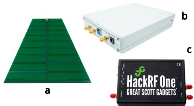
Figure 2: a) log periodic UHF antenna, b) Ettus B200 SDR, c) HackRF One SDR.
