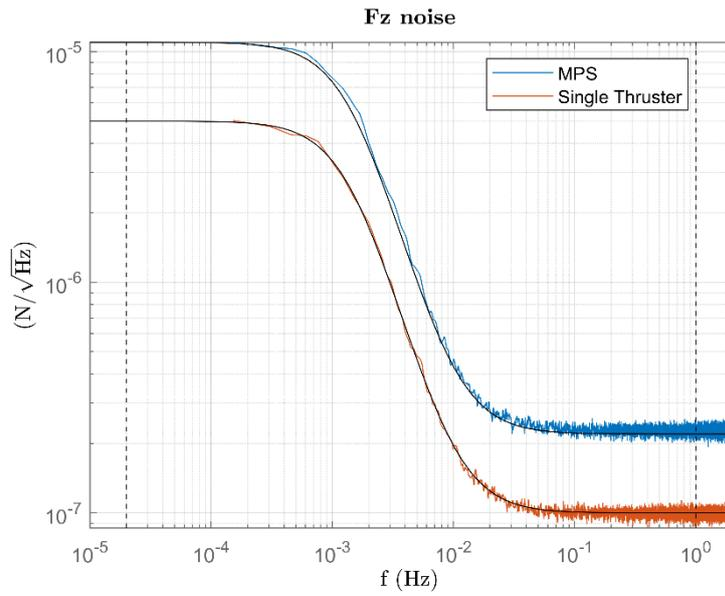
**Figure** Errore. Nel documento non esiste testo dello stile specificato. – MPS force noises. Red: single thruster. Blue: MPS system
