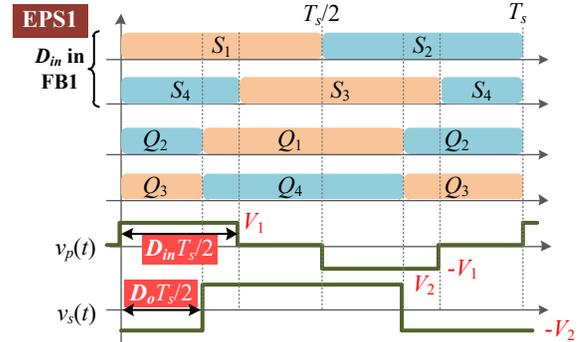
Fig. 2. Fundamentals of EPS1.
