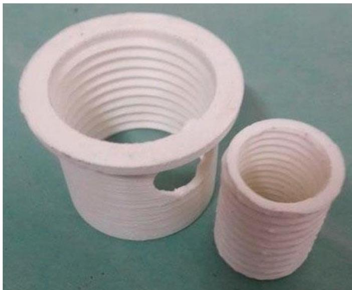
Рис. 5 – Распечатанные втулки для гидроциклона-демпфера
