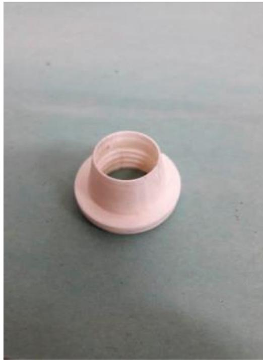
Рис. 6 – Распечатанный дисковый отражатель гидроциклона
