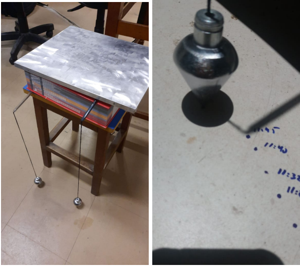
Figura 3. Esquerda: Um esquema de montagem do aparato utilizado neste trabalho. Direita: foto das medidas de projeção das sombras da ponta da caneta feitas no chão, para vários intervalos de tempo.
