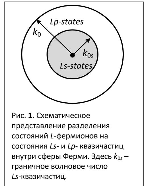
Рис. 1. Схематическое представление разделения состояний  $L$ -фермионов на состояния  $Ls$ - и  $Lp$ - квазичастиц внутри сферы Ферми. Здесь  $k_{0s}$  – граничное волновое число  $Ls$ -квазичастиц.
