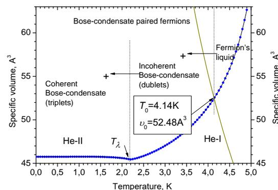
Рис. 2. Определение температуры бозе-конденсации гиротонных фермионов. Экспериментальная зависимость удельного объема жидкого гелия от температуры показана сплошными кружочками, соединенными линией. Связь между удельным объемом и температурой Ферми системы фермионов (ур.( 5)) показана сплошной линией. Точка пересечения определяет термодинамические параметры жидкого гелия, при которых реализуются условия бозонизации гиротонной системы.
