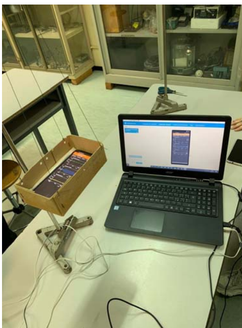
Figura 7: Misura del periodo di oscillazione del pendolo con PhyPhox presso il Liceo Scientifico “L. Trafelli” di Nettuno (FR), a.s. 2020/21.
