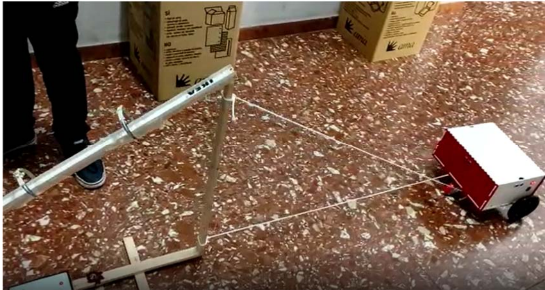
Figura 9: Robot MARRtino durante un esperimento sul piano inclinato in movimento presso il Liceo Scientifico “Aristotele” di Roma, a.s. 2020/21.
