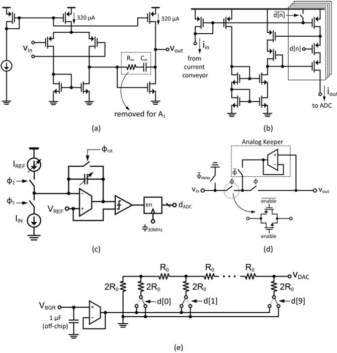
Fig. 10. Circuit schematics: (a) OTAs. (b) RGC. (c) Dual-slope ADC. (d) Tri-switch. (e) R-2R DAC.
