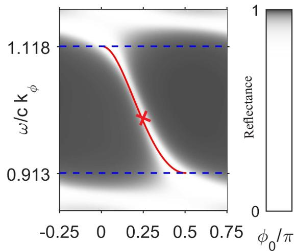
Рис. 2. Спектр отражения границы при различных углах  $\varphi$  между оптическими осями на границе. Синим пунктиром обозначены края фотонной запрещенной зоны. Красная сплошная кривая отражает аналитическую зависимость (10) Красный крестик при  $\varphi = \pi/4$  и  $\kappa = \tau$  соответствует параметрам рис. 1,а.
