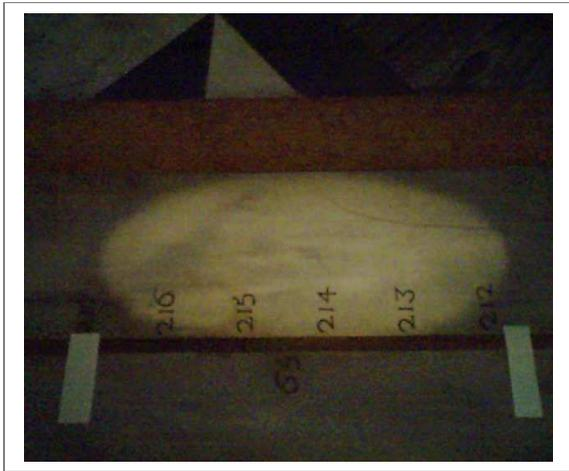
L'immagine solare è agitata da una continua turbolenza, generata dall'aria calda in movimento sul piano, fatto di mattoni, adiacente al foro stenopeico che si trova all'aria aperta. I mattoni sono scaldati dal Sole di mezzogiorno che anche d'Inverno li porta ad una temperatura maggiore di quella ambiente, da cui i moti turbolenti. Il passaggio di una bolla d'aria calda di dimensioni simili all'apertura del foro produce un sussulto dell'intera immagine del Sole sul piano
