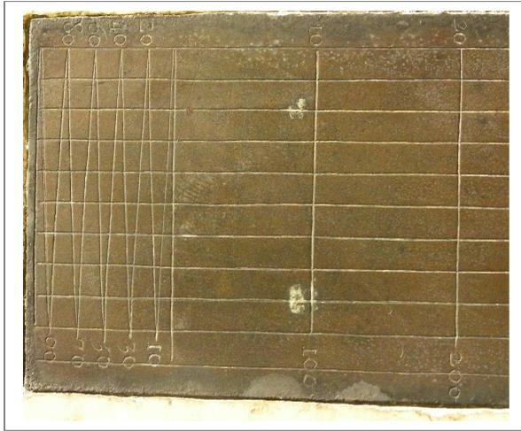
Nel muro settentrionale del presbiterio è murato un regolo “ticonico” che dimostra il tipo di strumento usato. Ha 9 righe orizzontali invece di 10, comunque aiuta a capire il suo funzionamento. Fu il grande astronomo danese Tycho Brahe (1546-1601) ad inventare questa scala a zig zag che perciò si chiama “ticonica”.
