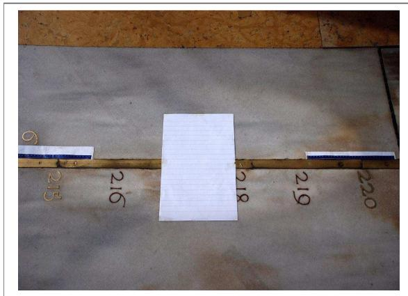
La foto qui sopra è del 24 dicembre 2007, e mostra l'apparato per la misurazione dei transiti paralleli delle posizioni dei lembi del Sole sulla linea meridiana. L'ellissi solare è lunga un metro e 10 cm.
