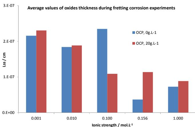
Figure 4: Valeurs moyennes de l'épaisseur de la couche d'oxydes calculées grâce au PDM-fretting. 0,156 M de force ionique pour la solution de Ringer (NaCl : 8,5 g.L<sup>-1</sup>, KCl : 0,25 g.L<sup>-1</sup>, CaCl<sub>2</sub>, 2H<sub>2</sub>O : 0,22 g.L<sup>-1</sup>, NaHCO<sub>3</sub> : 0,15 g.L<sup>-1</sup>); ces valeurs proviennent des 12 SIE enregistrés durant 1 expérience de fretting corrosion.
