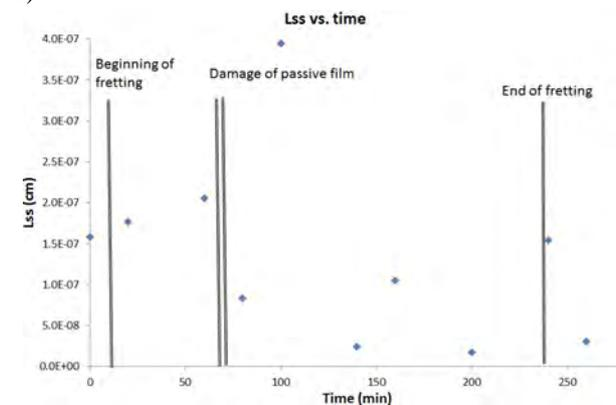
Figure 3 épaisseur du film d'oxydes de l'acier inoxydable 316L en fonction du temps durant une expérience de fretting corrosion, 10<sup>-2</sup> mol.L<sup>-1</sup>, 14,400 secondes a) modélisation sans albumine b) avec albumine.
