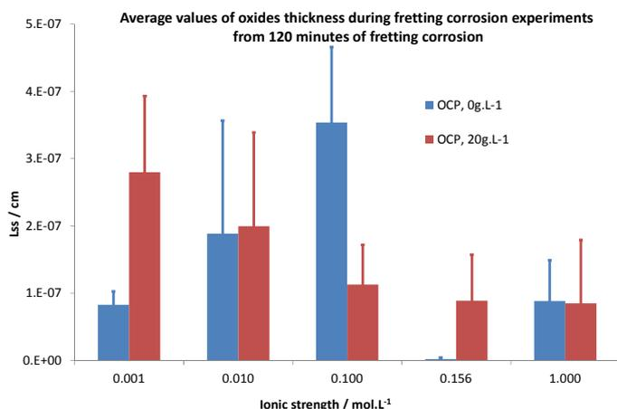
Figure 5: Les valeurs moyennes de la couche d'oxydes calculées par le modèle PDM-fretting. 0,156 mol.L<sup>-1</sup> de force ionique correspond à celle de la solution de Ringer (NaCl : 8,5 g.L<sup>-1</sup>, KCl : 0,25 g.L<sup>-1</sup>, CaCl<sub>2</sub>, 2H<sub>2</sub>O : 0,22 g.L<sup>-1</sup>, NaHCO<sub>3</sub> : 0,15 g.L<sup>-1</sup>); ces valeurs sont issues des 7 dernières expériences d'EIS, après un temps d'incubation de 100 minutes.
