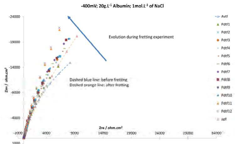
Figure 1: Diagrammes de Nyquist obtenus lors d'une expérience de fretting corrosion, potentiel imposé -400 mV/ECS, 1 mol.L<sup>-1</sup> de NaCl et 20 g.L<sup>-1</sup> d'albumine. Avtf: avant fretting; Apf: après fretting, Pdtf(i): pendant l'expérience de fretting corrosion
