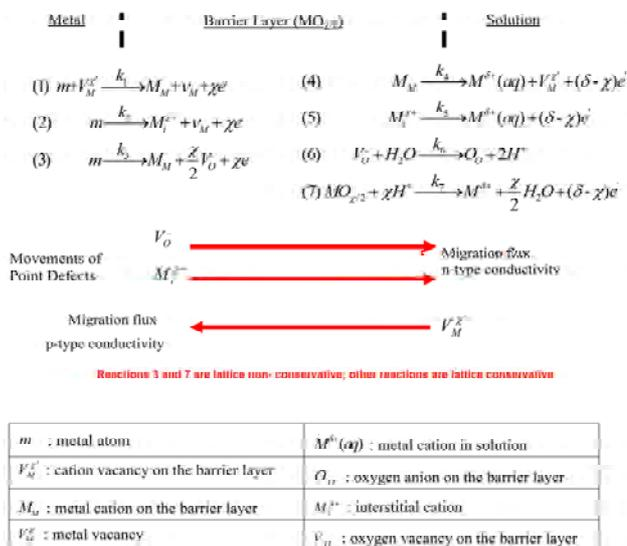
Figure 2 7 réactions du Point Defect Model, approche déterministe [7].
