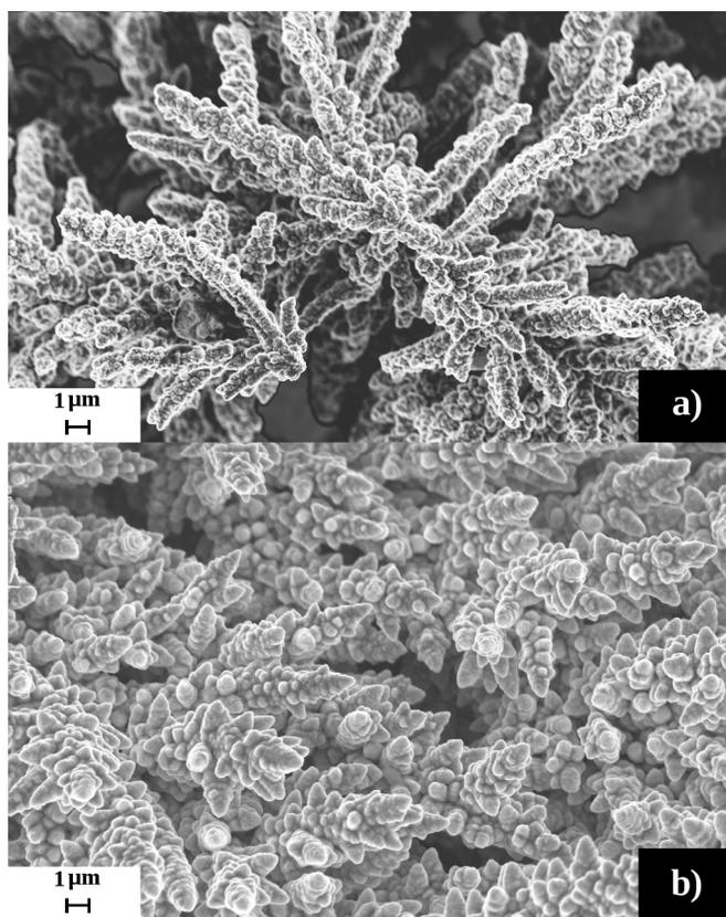
**Figure 4.** PdNi alloy a) «coral branch» and b) «coniferous branch».
