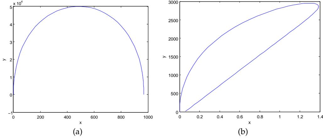
Figura 5: (a) Traiettorie dell'ascensore in assenza (linea tratteggiata) e in presenza (linea continua) di aria,  $\omega = 2\pi/(24 \cdot 3600)$  rad/s  $\simeq 7.27 \cdot 10^{-5}$  rad/s,  $g = 10$  m/s<sup>2</sup>,  $\gamma = 0.1$  kg/s,  $m = 1000$  kg. (b) Traiettorie dell'ascensore in presenza di attrito viscoso dell'aria, assumendo  $m = 0.03$  kg.
