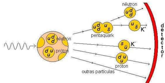
Figura 6 – Detecção das partículas usadas para reconstruir o estado de pentaquark  $\Theta^+$ . A formação do estado ressonante pentaquark é detectada devido ao seu decaimento em um nêutron  $n$  e num méson  $K^+$ . Nas reações que contém káons neutros, os pentaquarks podem ser identificados através do decaimento  $K^0 \rightarrow \pi^+ \pi^-$ .
