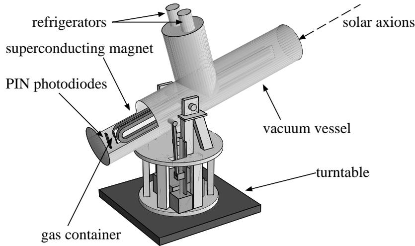
**FIGURE 1.** Tokyo axion helioscope
