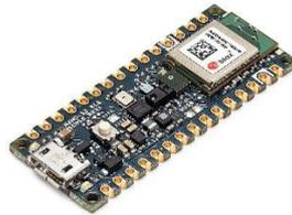
Fig. 2. Arduino Nano 33 BLE Sense.
