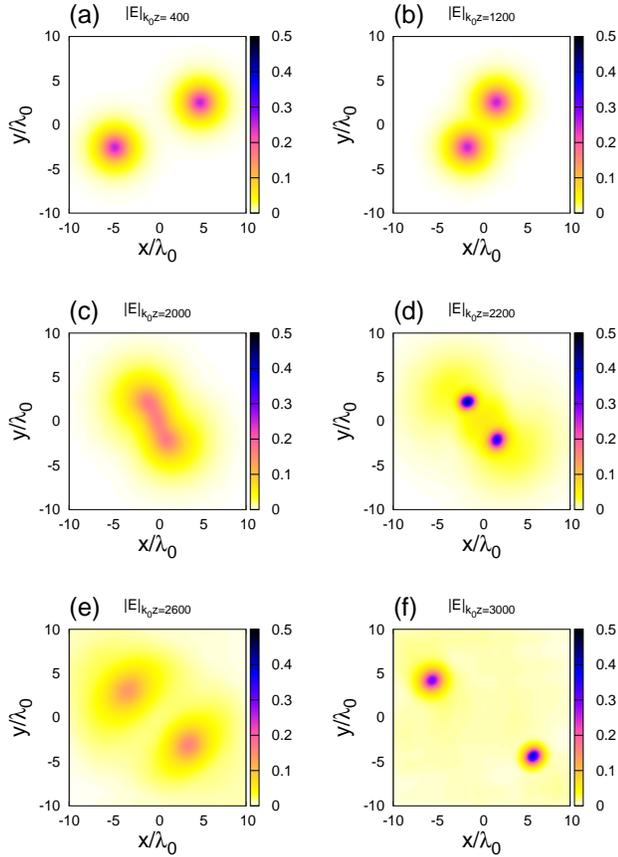
Рис. 3: Пример касательного столкновения двух тонких световых пучков с противоположными круговыми поляризациями.
