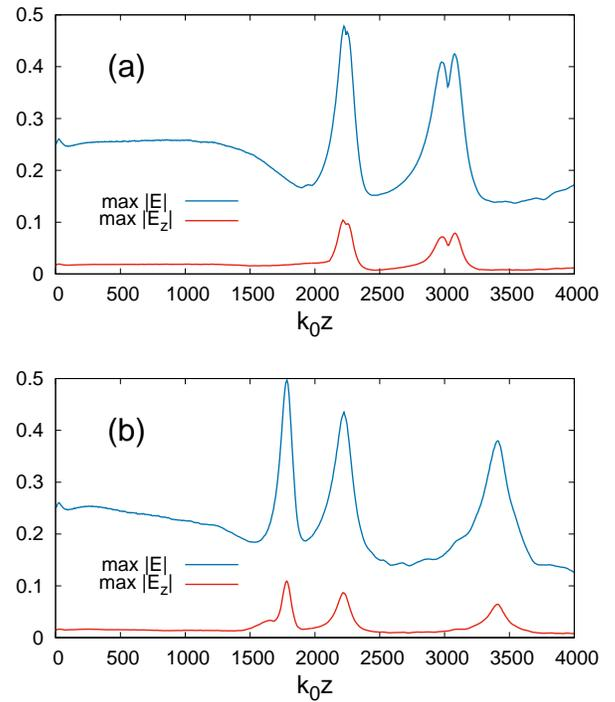
Рис. 4: Примеры зависимостей максимальной амплитуды поля от координаты  $z$  при взаимодействии двух пучков с противоположными круговыми поляризациями: (а) – для касательного столкновения, показанного на Рис. 3; (б) – для исходно параллельных пучков.
