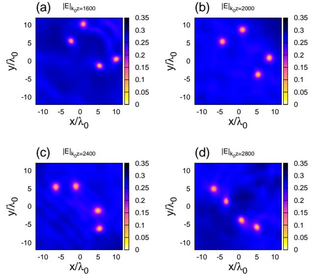
Рис. 5: Пример взаимодействующих оптических вихрей в поляризованной по кругу волне при дефокусирующей нелинейности.
