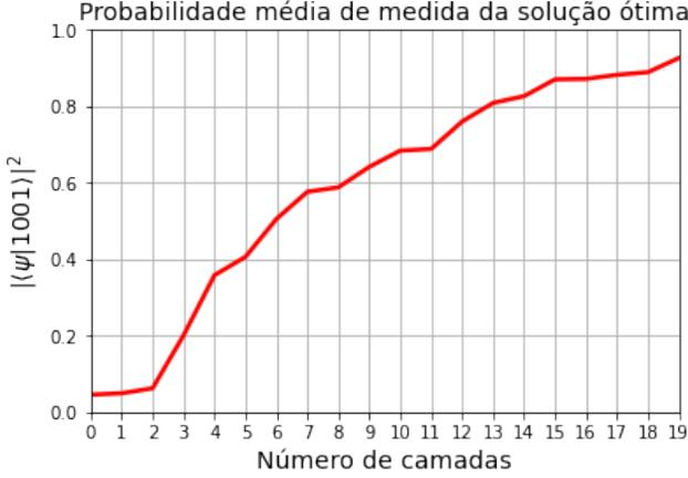
Figura 7. Probabilidade  $|\langle \psi(\beta, \gamma) | 1001 \rangle|^2$  de que o estado encontrado pelo QAOA seja encontrado na solução ótima  $|1001\rangle$ , plotada em função do número de camadas no QAOA. Para cada número de camadas, consideramos uma média sobre as duas melhores dentre 10 otimizações.
