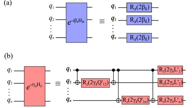
Figura 5. Circuitos implementando as unitárias (a)  $U_B$  e (b)  $U_C$ .
