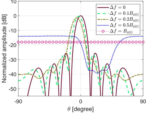
Fig. 5. FDA integral transmit beampattern.
