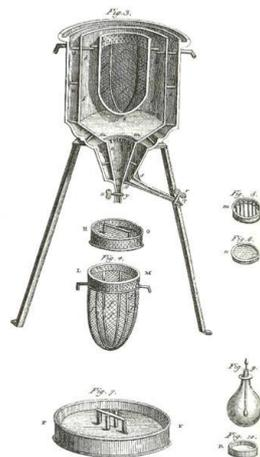
**Figura 17:** Ice-calorimeter de Lavoisier.<sup>33</sup>
