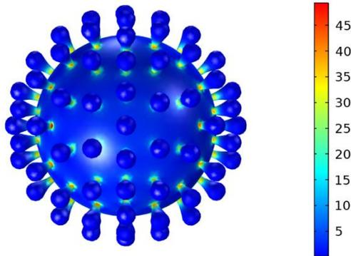
Time=90 ns      Surface: von Mises stress (N/m<sup>2</sup>)
