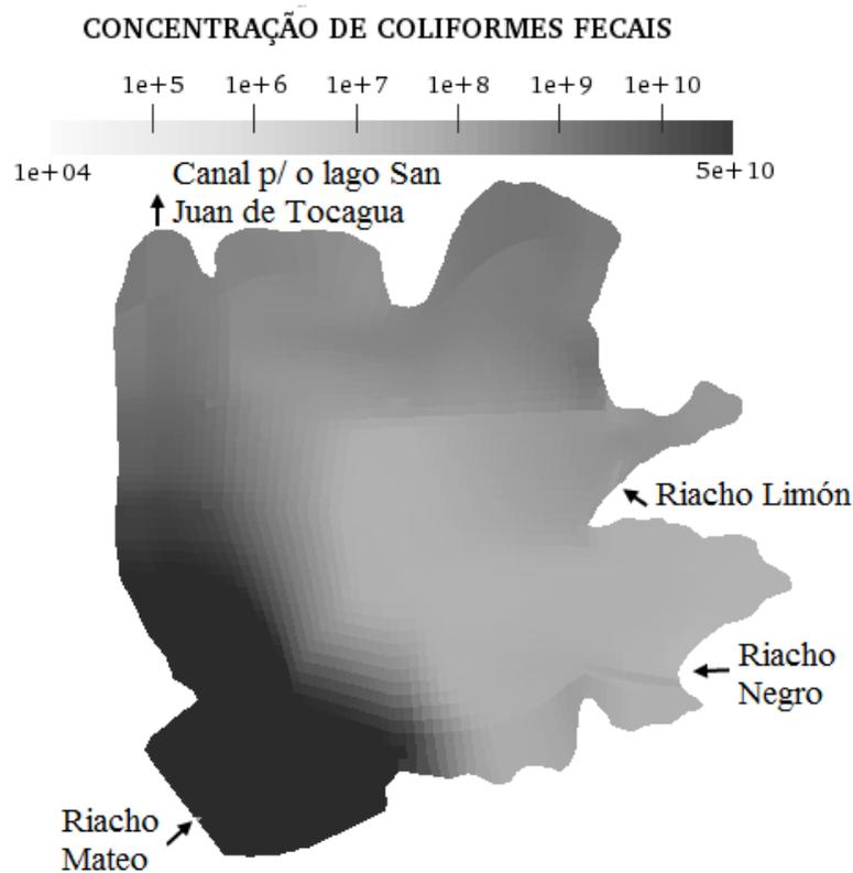
Figura 4: Simulação numérica do campo de concentrações de coliformes fecais gerado na malha multibloco do lago Luruaco para  $D = 3,6 \text{ m}^2/h$  e  $K = 0,02h^{-1}$ .
