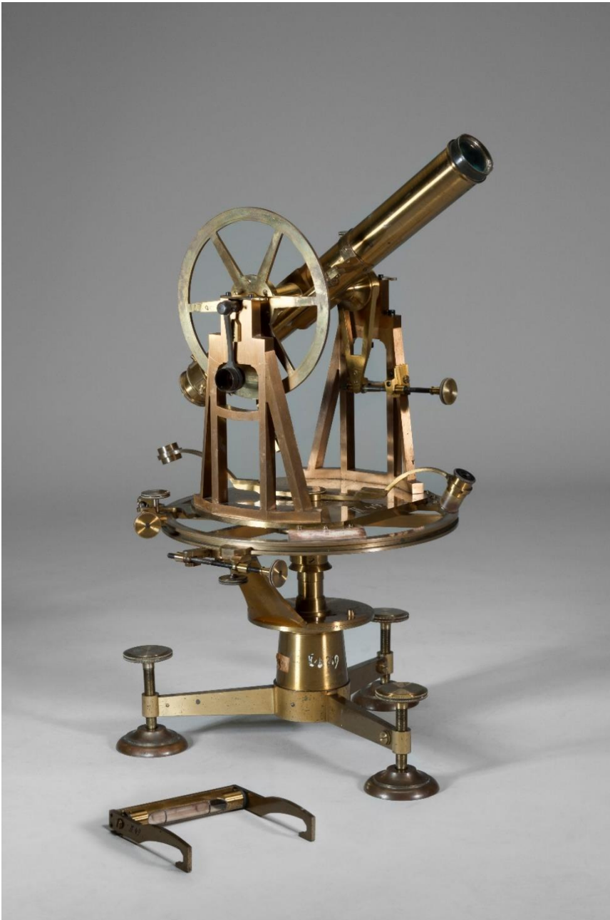
Universalinstrument oder auch Repetitions-theodolit von 1823, hergestellt von der Firma Breithaupt in enger Kooperation mit Christian Ludwig Gerling; eines der Messgeräte der Haupttriangulation Kurhessens Anfang des 19. Jahrhunderts.
