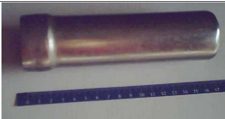
Figura 13. Tubo da 169 mm di lunghezza con 39 mm di diametro superiore e 46 mm di diametro inferiore. La correzione di end viene contata 2 volte per le due aperture e vale circa 1.2 cm per ogni apertura, mentre nel caso precedente era inferiore ai 5 mm perché il tubo era più sottile.
