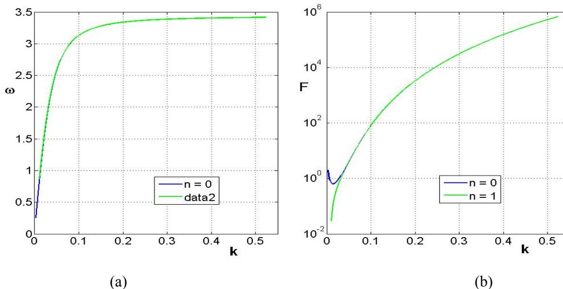
Рис. 13. Зависимость от волнового вектора частоты резонансного плазмона (а) и фактора  $F$  (б) для цилиндрических гармоник с  $n = 0,1$ . Волновой вектор в единицах  $[nm^{-1}]$ , частота в  $[eV]$ . При расчете приняты значения:  $\omega_{pl} = 9.1eV$ ;  $\epsilon_h = 6$ ;  $\rho = 200nm$ .
