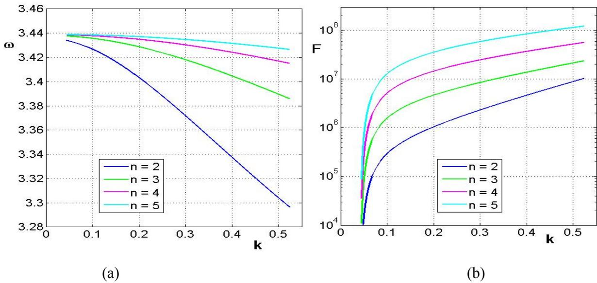
Рис. 8. Зависимость от волнового вектора частоты резонансного плазмона (а) и фактора  $F$  (б) для цилиндрических гармоник с  $n = 2,3,4,5$ . Волновой вектор в единицах  $[nm^{-1}]$ , частота в  $[eV]$ . При расчете приняты значения:  $\omega_{pl} = 9.1eV$ ;  $\epsilon_h = 6$ ;  $\rho = 2nm$ .
