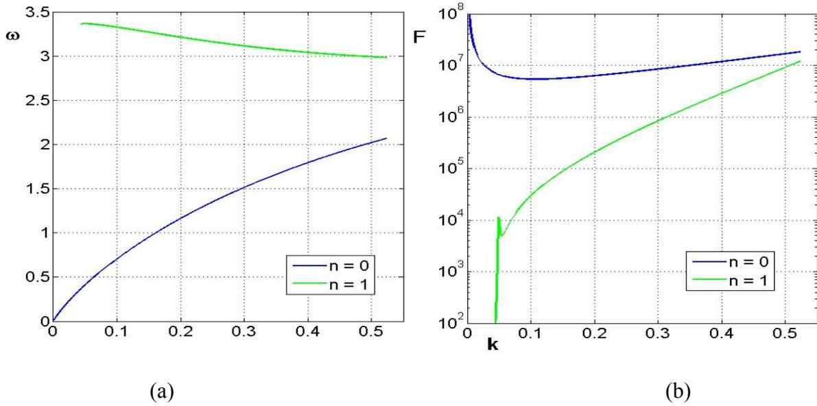
Рис. 7. Зависимость от волнового вектора частоты резонансного плазмона (а) и фактора  $F$  (б) для цилиндрических гармоник с  $n = 0,1$ . Волновой вектор в единицах  $[nm^{-1}]$ , частота в  $[eV]$ . При расчете приняты значения:  $\omega_{pl} = 9.1eV$ ;  $\epsilon_h = 6$ ;  $\rho = 2nm$ .
