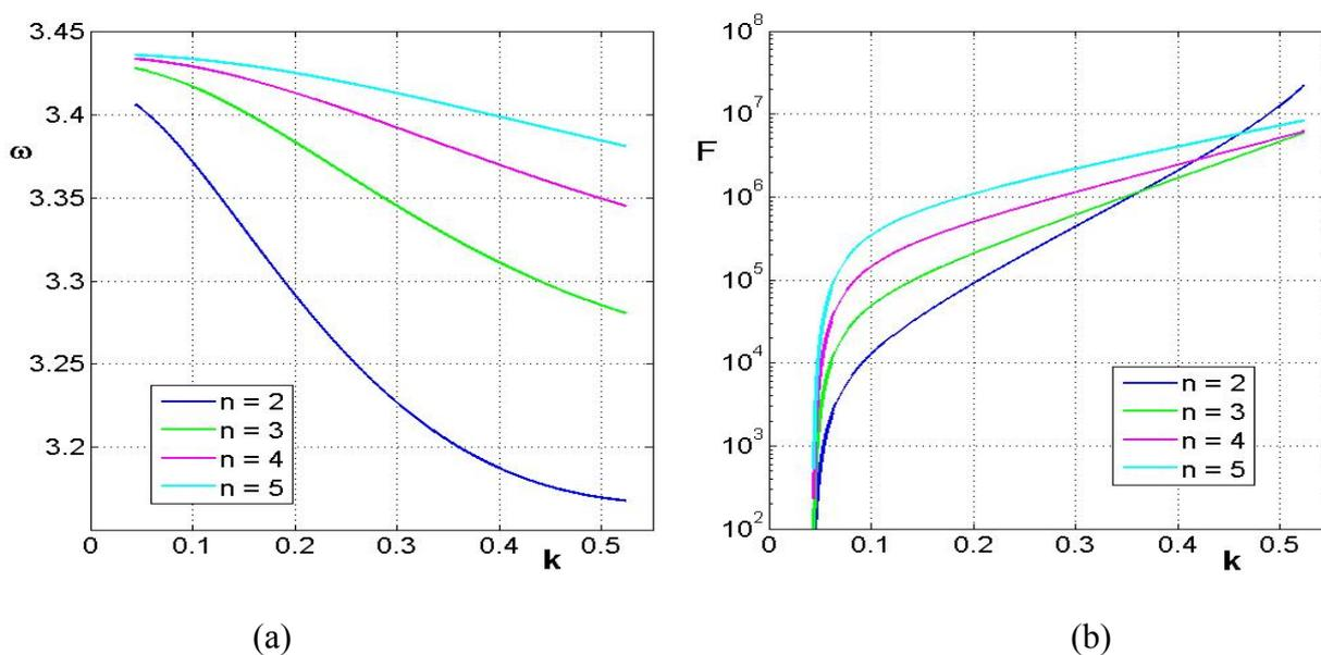
Рис. 10. Зависимость от волнового вектора частоты резонансного плазмона (а) и фактора  $F$  (б) для цилиндрических гармоник с  $n = 2,3,4,5$ . Волновой вектор в единицах  $[nm^{-1}]$ , частота в  $[eV]$ . При расчете приняты значения:  $\omega_{pl} = 9.1eV$ ;  $\epsilon_h = 6$ ;  $\rho = 5nm$ .
