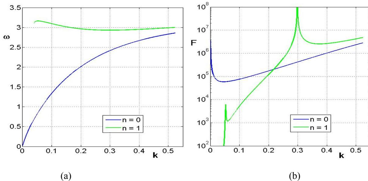
Рис. 9. Зависимость от волнового вектора частоты резонансного плазмона (а) и фактора  $F$  (б) для цилиндрических гармоник с  $n = 0,1$ . Волновой вектор в единицах  $[nm^{-1}]$ , частота в  $[eV]$ . При расчете приняты значения:  $\omega_{pl} = 9.1eV$ ;  $\epsilon_h = 6$ ;  $\rho = 5nm$ .
