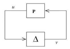
Figure 1 :  $\mathbf{P} - \Delta$  feedback connection
